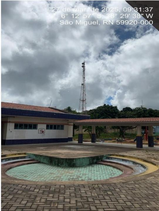
**Figura 01 - Pátio descoberto, a ser coberto com estrutura metálica e telhas de fibrocimento.**
